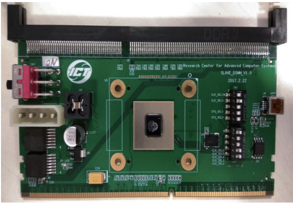
图 4 基于自研 DDR3 buffer 芯片的内存接口扩展卡
