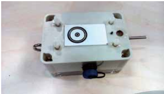
图 1 用于单点测量的 CTD 传感器样机
