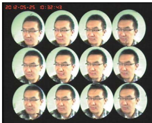
图 1. 多视角集成成像系统获取的图像阵列
