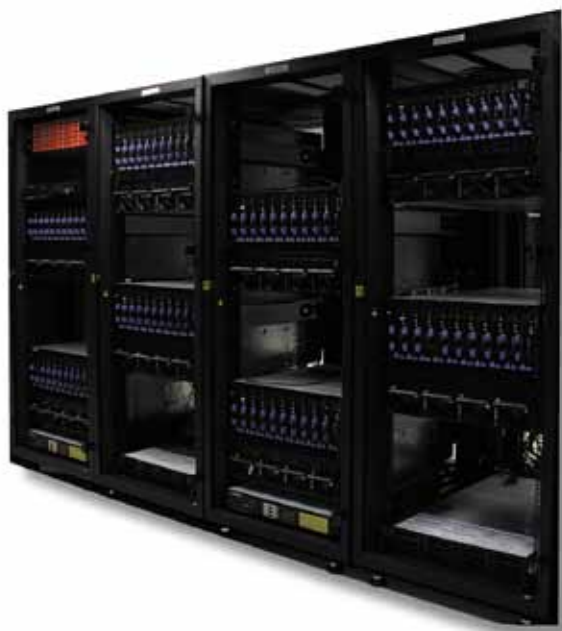
超龙一号系统 X86+GPU 加速部分（4 个机柜，80 个 X86+GPU 节点）
