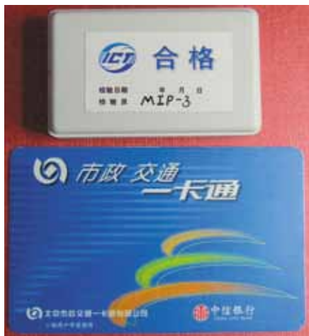
图 12: 基于 WiFi 的小型、低功耗定位标签
