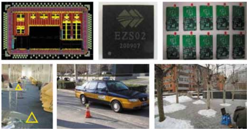
图（上）从左到右分别是芯片设计版图、SIP 封装后的芯片实物图以及基于该芯片的传感网节点平台 （下）从左到右分别是室内环境监测系统、智能交通监测系统以及生态环境监测验证场景
